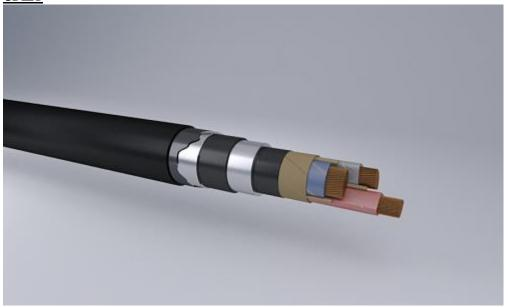
Кабели силовые с медной жилой, бумажной пропитанной изоляцией, в свинцовой оболочке, с защитным покровом типа БШв
