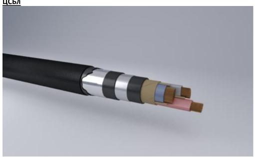
Кабели силовые с медной жилой, бумажной изоляцией пропитанной нестекающим составом, в свинцовой оболочке, с защитным покровом типа Бл
