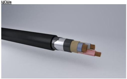
Кабели силовые с медной жилой, бумажной изоляцией пропитанной нестекающим составом, в свинцовой оболочке, с защитным покровом типа Шв
