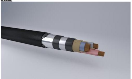
Кабели силовые с медной жилой, бумажной изоляцией пропитанной нестекающим составом, в свинцовой оболочке, с защитным покровом типа Б2л
