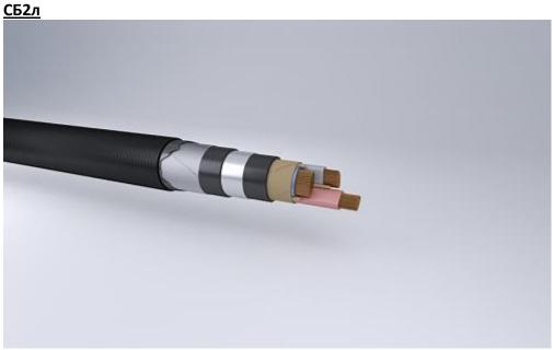
Кабели силовые с медной жилой, бумажной пропитанной изоляцией, в свинцовой оболочке, с защитным покровом типа Б2л
