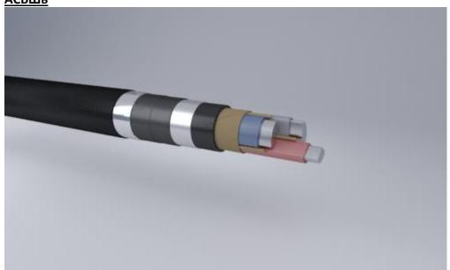
Кабели силовые с алюминиевой жилой, бумажной пропитанной изоляцией, в свинцовой оболочке, с защитным покровом типа БШв
