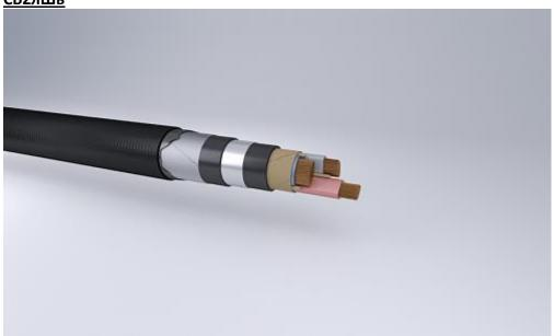
Кабели силовые с медной жилой, бумажной пропитанной изоляцией, в свинцовой оболочке, с защитным покровом типа Б2лШв
