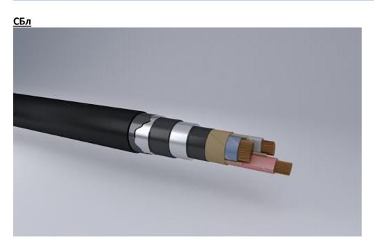
Кабели силовые с медной жилой, бумажной пропитанной изоляцией, в свинцовой оболочке, с защитным покровом типа Бл
