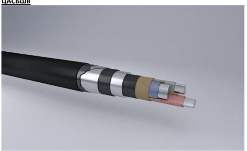
Кабели силовые с алюминиевой жилой, бумажной изоляцией пропитанной нестекающим составом, в свинцовой оболочке, с защитным покровом типа БШв
