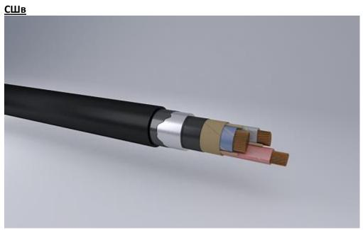
Кабели силовые с медной жилой, бумажной пропитанной изоляцией, в свинцовой оболочке, с защитным покровом типа Шв
