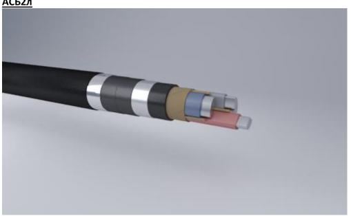
Кабели силовые с алюминиевой жилой, бумажной пропитанной изоляцией, в свинцовой оболочке, с защитным покровом типа Б2л
