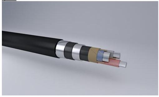
Кабели силовые с алюминиевой жилой, бумажной изоляцией пропитанной нестекающим составом, в свинцовой оболочке, с защитным покровом типа Бл
