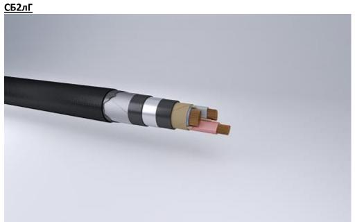
Кабели силовые с медной жилой, бумажной пропитанной изоляцией, в свинцовой оболочке, с защитным покровом типа Б2лГ
