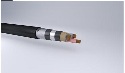
Кабели силовые с медной жилой, бумажной пропитанной изоляцией, в свинцовой оболочке, с защитным покровом типа БлШв
