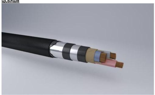
Кабели силовые с медной жилой, бумажной изоляцией пропитанной нестекающим составом, в свинцовой оболочке, с защитным покровом типа БлШв
