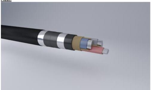
Кабели силовые с алюминиевой жилой, бумажной пропитанной изоляцией, в свинцовой оболочке, с защитным покровом типа Бл
