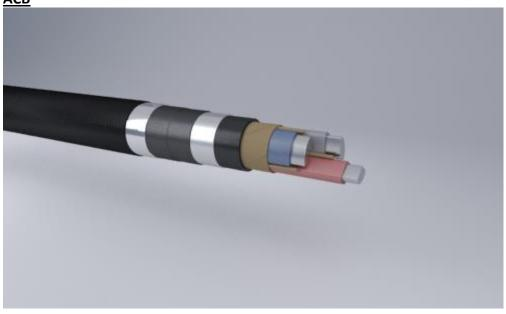
Кабели силовые с алюминиевой жилой, бумажной пропитанной изоляцией, в свинцовой оболочке, с защитным покровом типа Б
