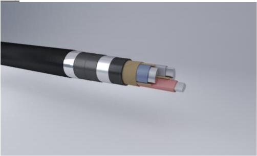
Кабели силовые с алюминиевой жилой, бумажной пропитанной изоляцией, в алюминиевой, с защитным покровом типа Бл
