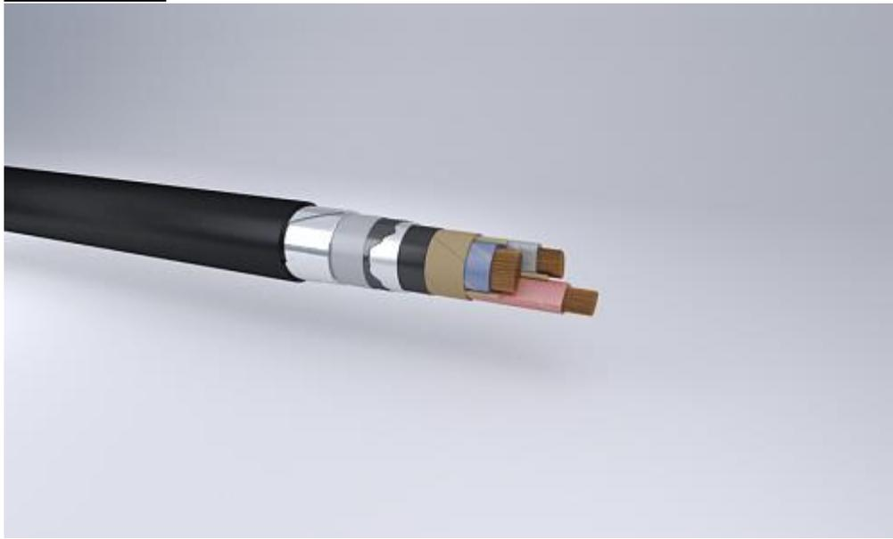
Кабели силовые с медной жилой, бумажной изоляцией пропитанной нестекающим составом, в свинцовой оболочке, с защитным покровом бронированного типа со шлангом из ПВХ композиции пониженной пожароопасности с низким дымо-и газовыделением
