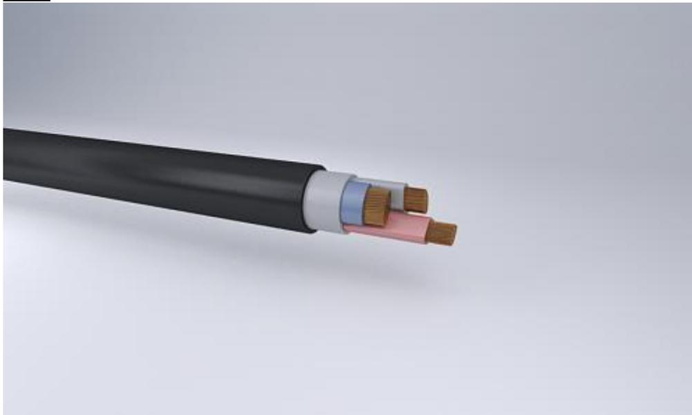
Кабели силовые с медными жилами, изоляция из вулканизированного полиэтилена и оболочка из ПВХ пластиката, без защитного покрова
