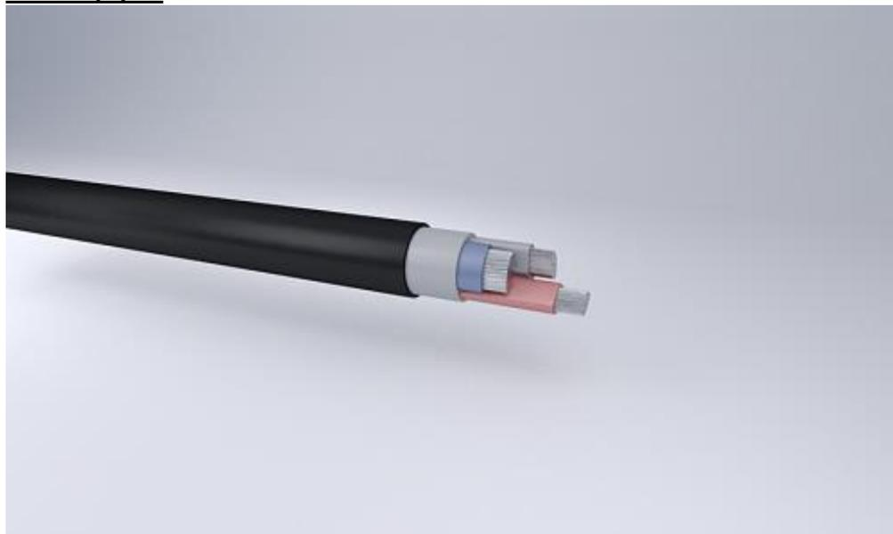
Кабели силовые с алюминиевыми жилами, изоляция и оболочка из ПВХ композиции пониженной пожароопасности, с низким дымо-и газовыделением, без защитного покрова
