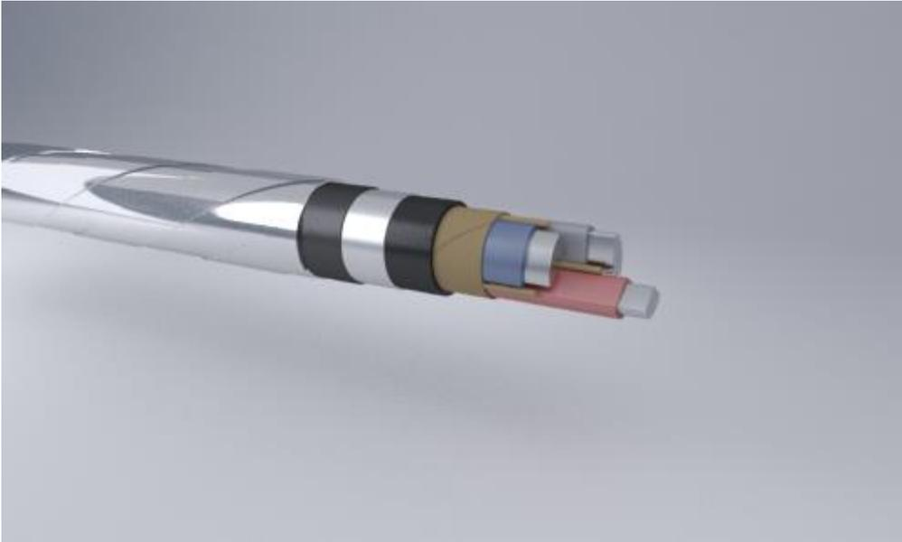
Кабели силовые с алюминиевой жилой, бумажной пропитанной изоляцией, в алюминиевой, с защитным покровом типа БнлГ
