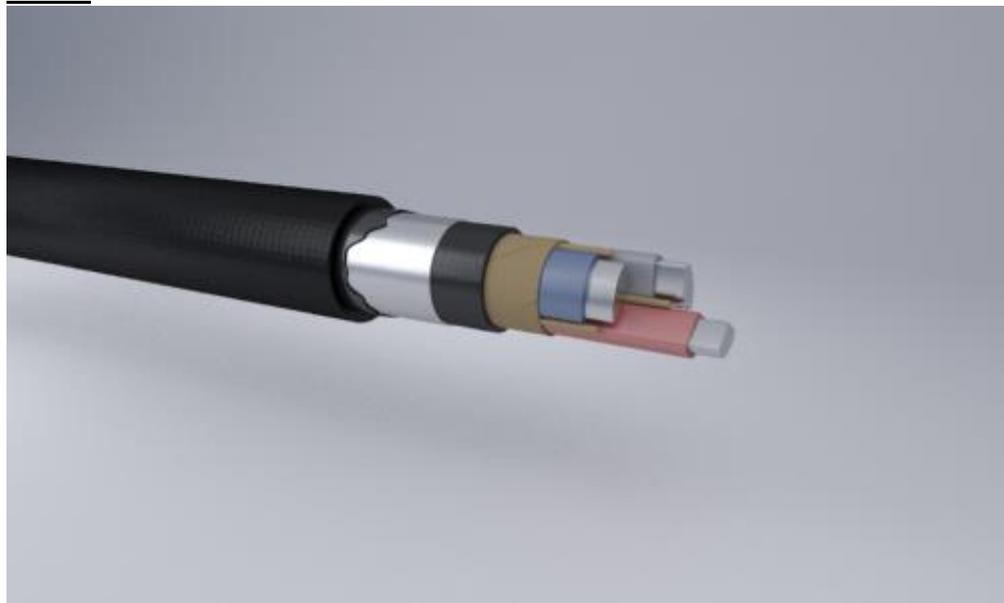
Кабели силовые с алюминиевой жилой, бумажной пропитанной изоляцией, в алюминиевой с защитным покровом типа Шв
