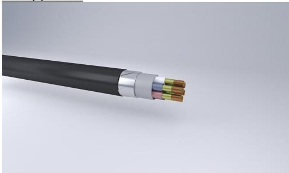
Кабели контрольные с медными жилами, с изоляцией и оболочкой из полимерных композиций, не содержащих галогенов, с огнестойким барьером, бронированные
