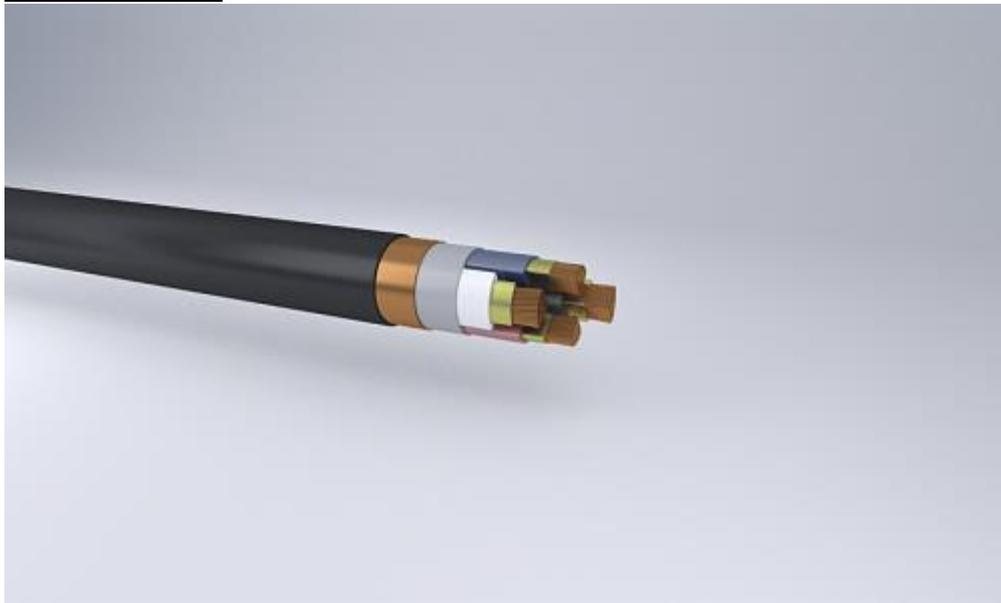
Кабели силовые с медными жилами, изоляция и оболочка из полимерных композиций, не содержащих галогенов, с огнестойкими барьерами, экранированные
