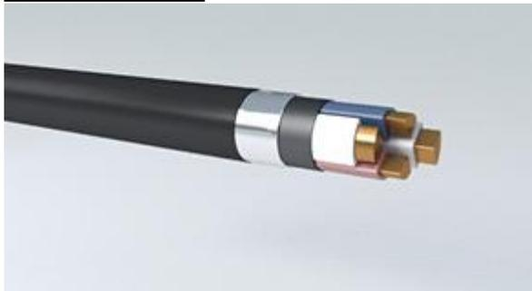
Кабели силовые с медными жилами с изоляцией и защитной оболочкой из ПВХ композиции пониженной пожароопасности, с низким дымо- и газовыделением, с огнестойкими барьерами, с общим экраном из медной ленты
