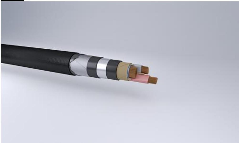
Кабели силовые с медной жилой, бумажной пропитанной изоляцией, в свинцовой оболочке, с защитным покровом типа БлШв
