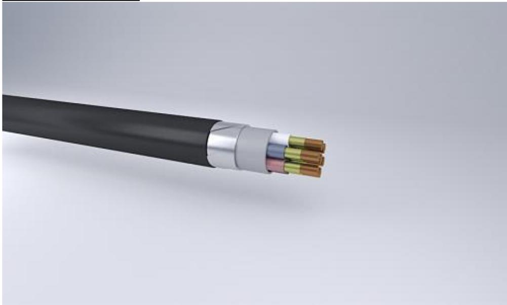
Кабели контрольные с медными жилами, с изоляцией и оболочкой из поливинилхлоридного пластика пониженной пожарной опасности с низким дымо- и газовыделением, с огнестойкими барьерами, бронированные
