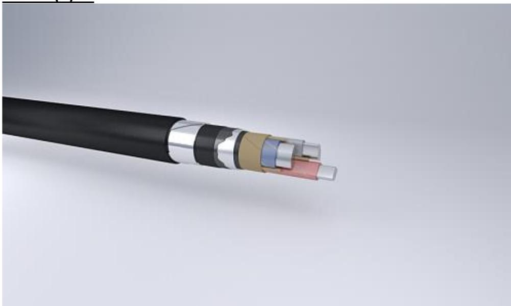
Кабели силовые с алюминиевой жилой, бумажной пропитанной изоляцией, в свинцовой оболочке с защитным покровом бронированного типа со шлангом из ПВХ композиции пониженной горючести с низким дымо-и газовыделением
