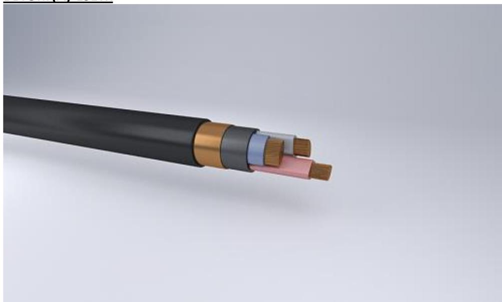
Кабели силовые с медными жилами, изоляция и оболочка из ПВХ композиции пониженной пожароопасности, с низким дымо-и газовыделением и низкой токсичностью продуктов горения, без защитного покрова, с общим экраном из медной ленты
