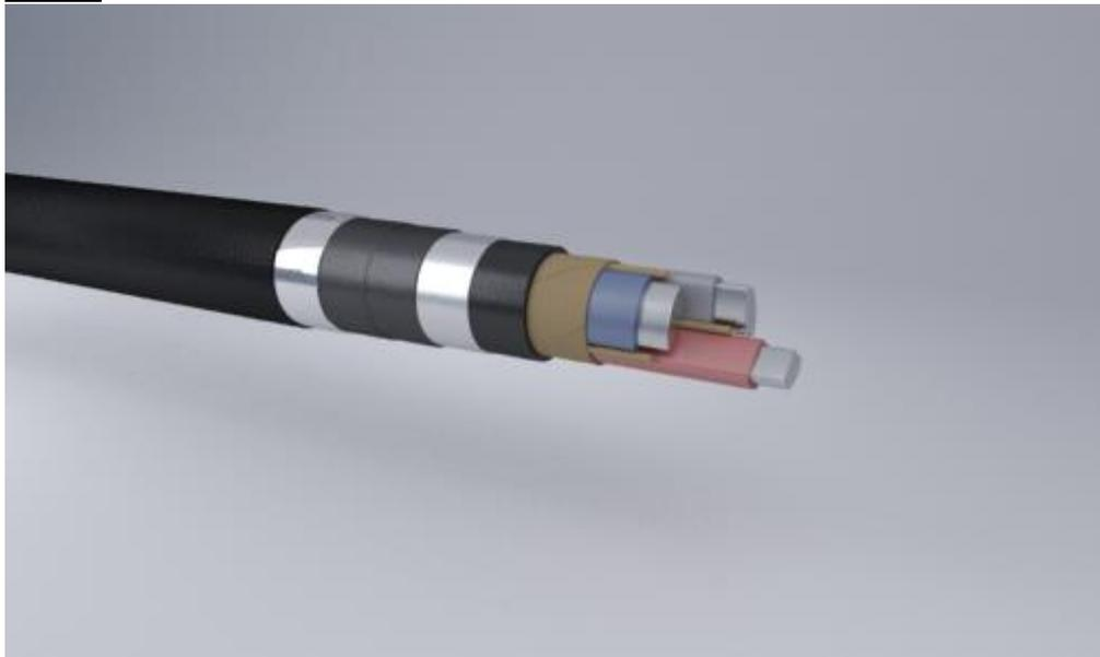
алюминиевой жилой, бумажной пропитанной изоляцией, в свинцовой оболочке, с защитным покровом типа Б2л
