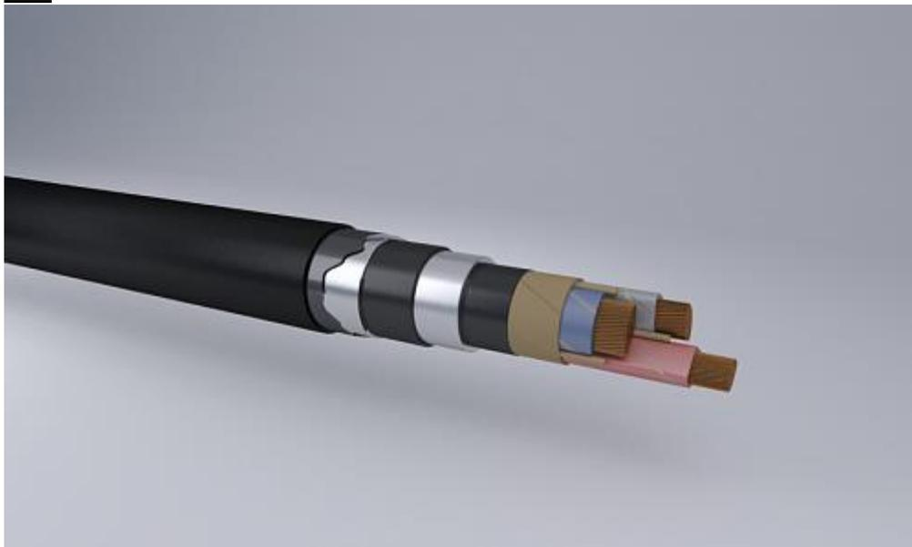
Кабели силовые с медной жилой, бумажной пропитанной изоляцией, в свинцовой оболочке, с защитным покровом типа Бл
