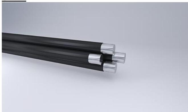
Провод самонесущий с алюминиевыми фазными токопроводящими жилами, изоляция из светостабилизированного сшитого полиэтилена с нулевой несущей жилой, изолированной светостабилизированным сшитым полиэтиленом
