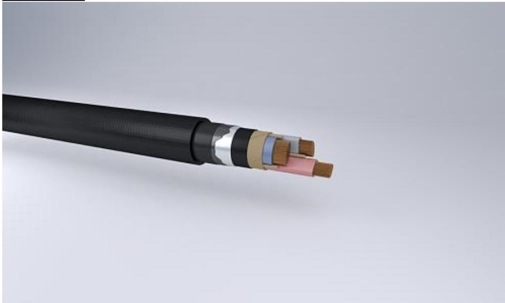
Кабели силовые с медной жилой, бумажной изоляцией, пропитанной нестекающим составом, в свинцовой оболочке, с защитным покровом шлангового типа из ПВХ композиции пониженной пожароопасности и огнезащитным барьером
