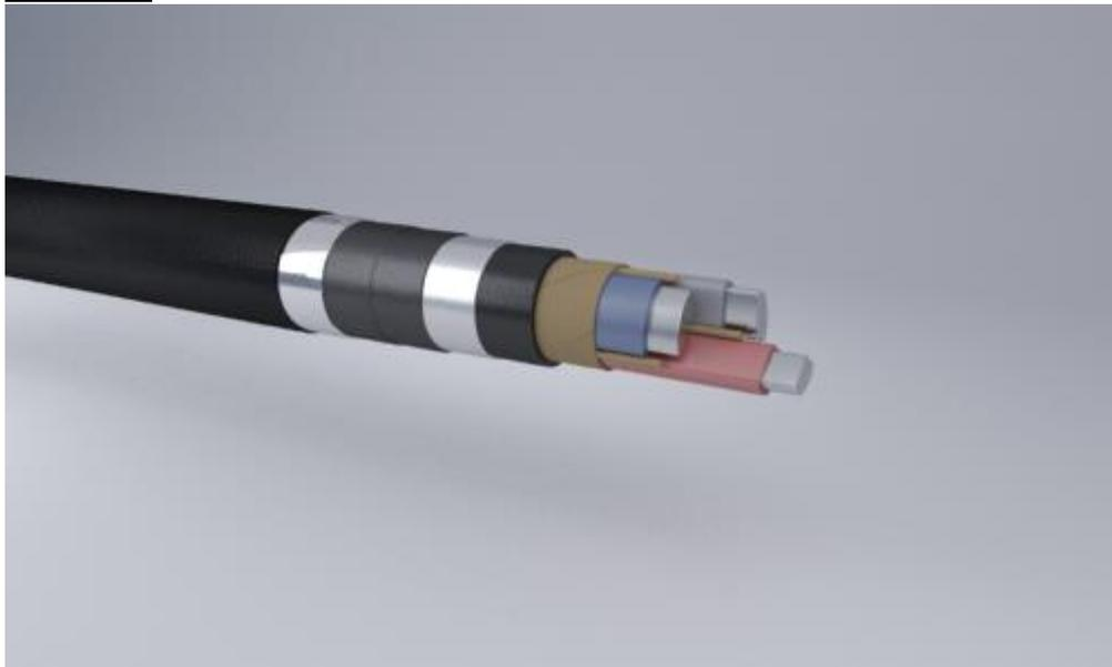
Кабели силовые с алюминиевой жилой, бумажной пропитанной изоляцией, в свинцовой оболочке, с защитным покровом типа Б2лШв
