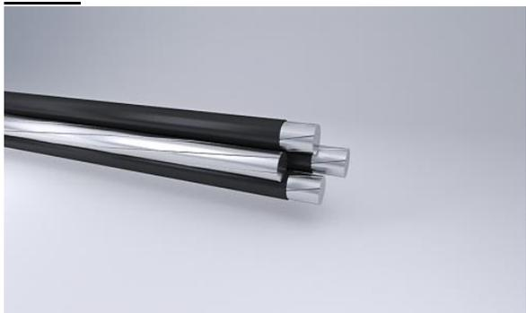
Провод самонесущий с алюминиевыми фазными токопроводящими жилами, изоляция из светостабилизированного сшитого полиэтилена с несущей неизолированной жилой из алюминиевого сплава
