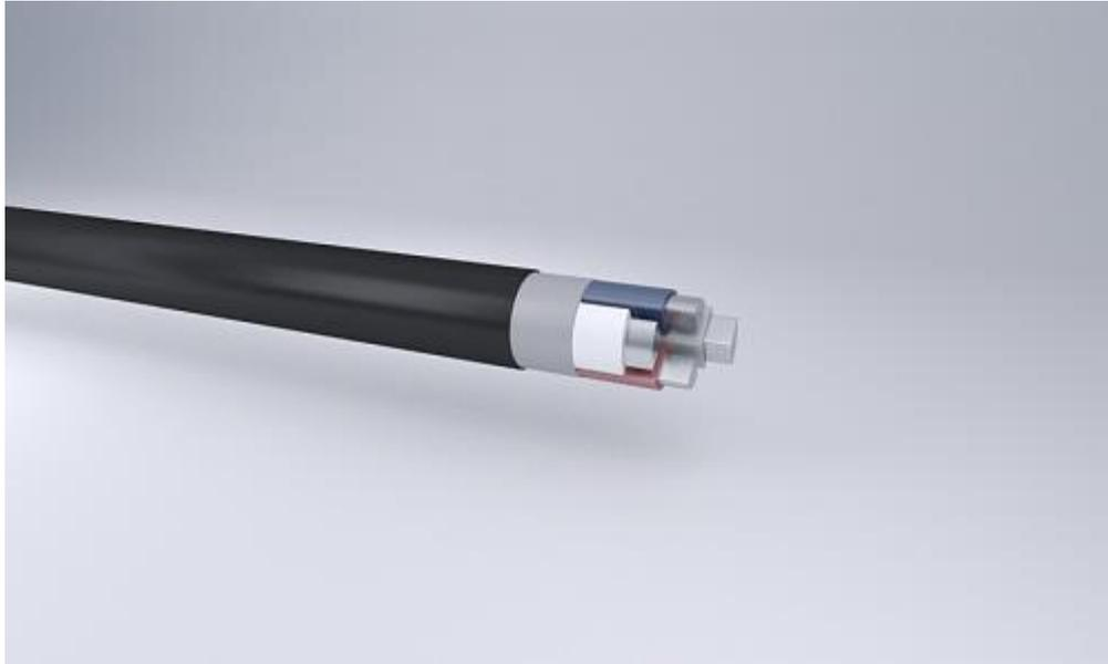
Кабели силовые с алюминиевыми жилами, изоляция из вулканизированного полиэтилена и оболочка из ПВХ пластиката, без защитного покрова
