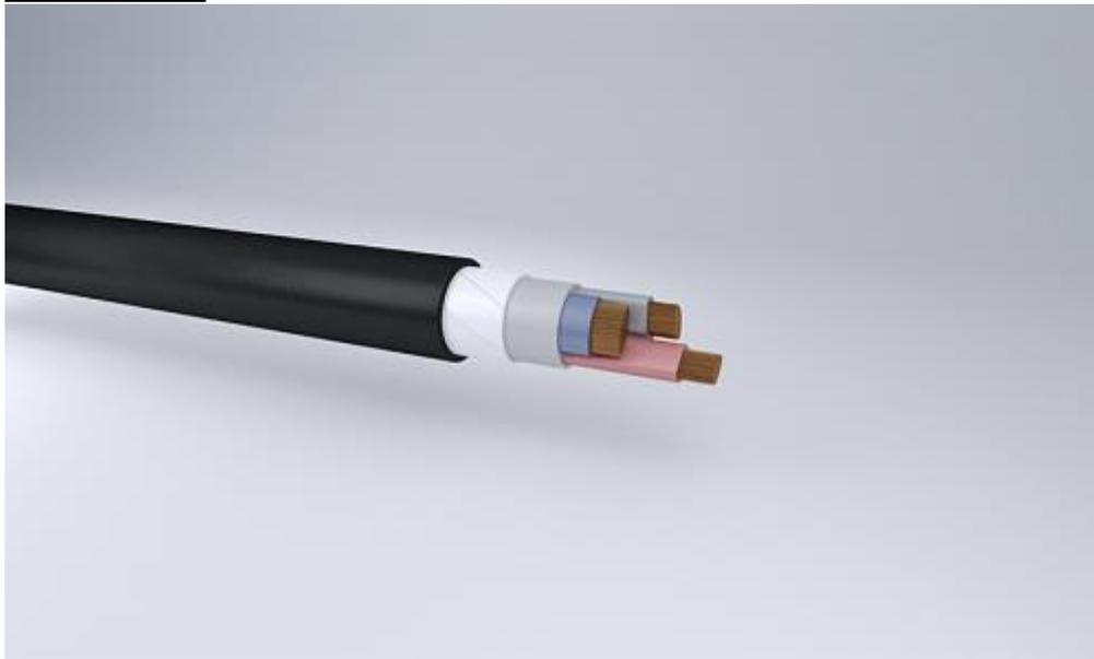
Кабели силовые с медными жилами, изоляция из сшитого полиэтилена, оболочка из полимерной композиции, не содержащей галогенов
