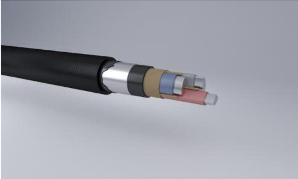
Кабели силовые с алюминиевой жилой, бумажной пропитанной изоляцией, в свинцовой оболочке, с защитным покровом типа Шв
