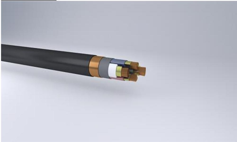
Кабели силовые с медными жилами, изоляция из сшитого полиэтилена, оболочка из полимерных композиций, не содержащих галогенов, с огнестойкими барьерами, экранированные
