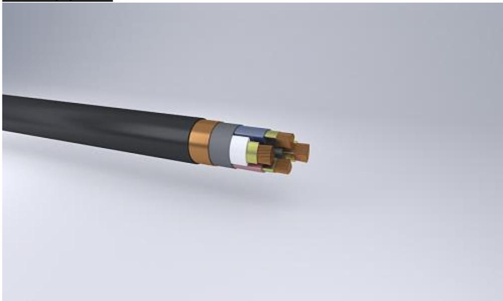
Кабели силовые с медными жилами, с термическим барьером по жилам, изоляция из сшитого полиэтилена, оболочка из полимерной композиции, не содержащей галогенов, в медном экране из медных лент
