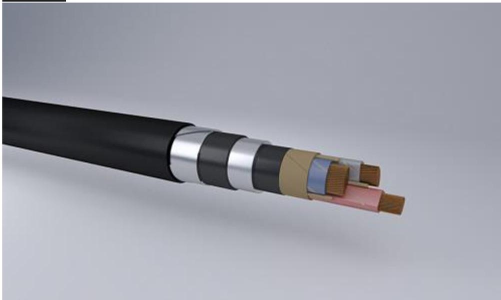
Кабели силовые с медной жилой, бумажной пропитанной изоляцией, в свинцовой оболочке, с защитным покровом типа БнлШнг
