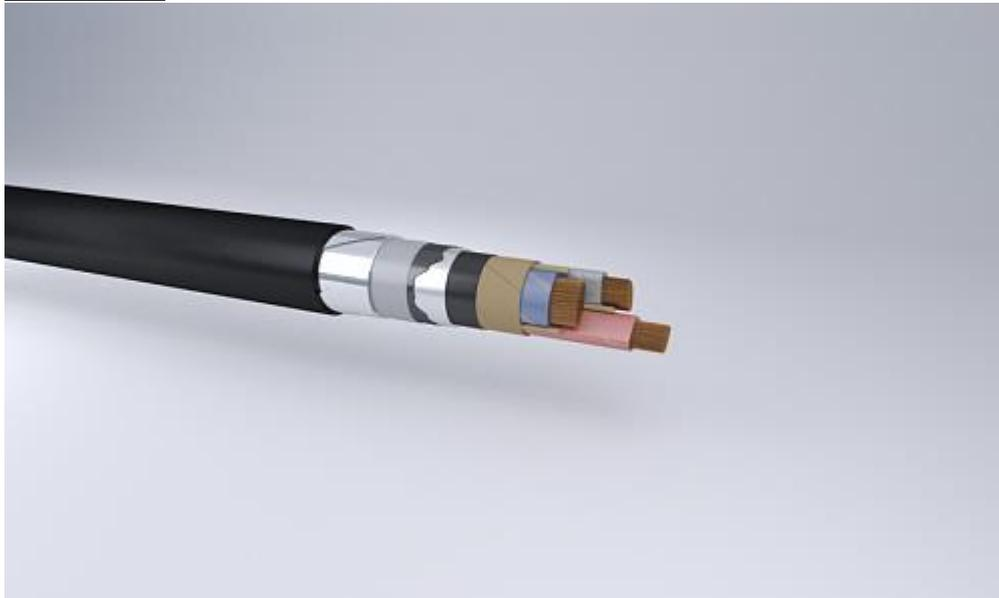
Кабели силовые с медной жилой, бумажной пропитанной изоляцией, в свинцовой оболочке, с защитным покровом бронированного типа со шлангом из ПВХ композиции пониженной пожароопасности с низким дымо-и газовыделением
