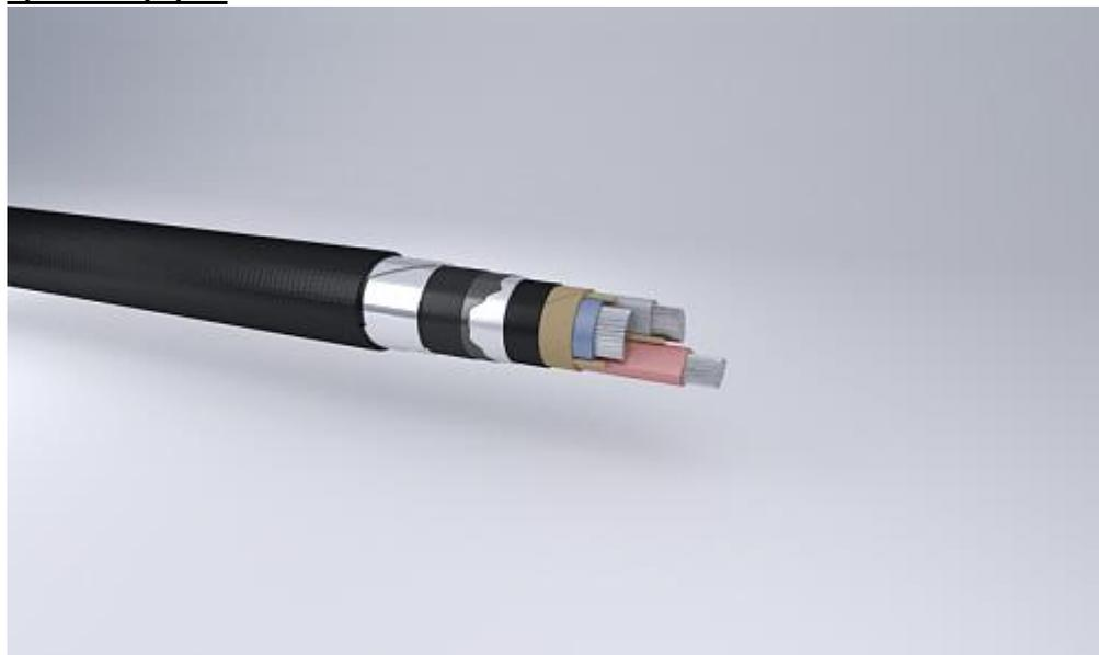
Кабели силовые с алюминиевой жилой, бумажной изоляцией пропитанной нестекающим составом, в свинцовой оболочке, с защитным покровом бронированного типа со шлангом из ПВХ композиции пониженной горючести с низким дымо-и газовыделением
