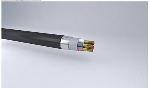
Кабели контрольные с медными жилами, с изоляцией и оболочкой из поливинилхлоридного пластиката пониженной пожарной опасности с низким дымо- и газовыделением, с огнестойкими барьерами,бронированные
