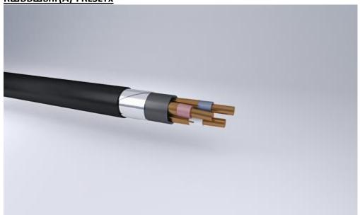
Кабели шахтные с изоляцией и оболочкой из поливинилхлоридных композиций пониженной пожароопасности, не распространяющие горение, с низким дымо- и газовыделением, и низкой токсичностью продуктов горения, бронированные,с огнестойким барьером
