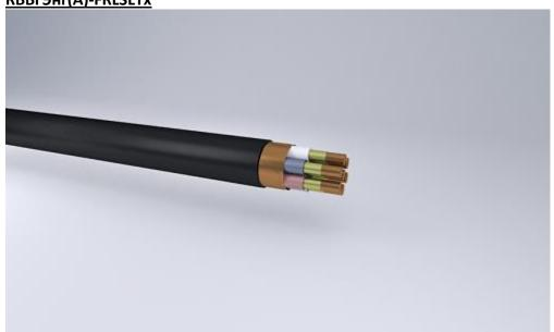
Кабели контрольные с медными жилами, с изоляцией и оболочкой из поливинилхлоридного пластиката пониженной пожарной опасности с низким дымо- и газовыделением и низкой токсичностью продуктов горения, с огнестойкими барьерами, в общем экране из медной ленты
