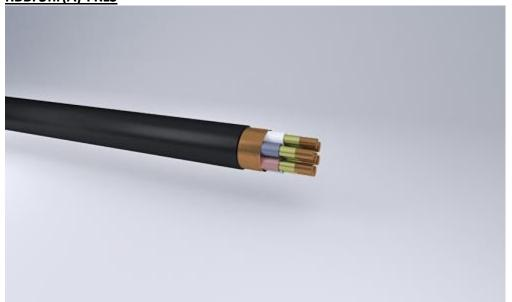
Кабели контрольные с медными жилами, с изоляцией и оболочкой из поливинилхлоридного пластиката пониженной пожарной опасности с низким дымо- и газовыделением, с огнестойкими барьерами, экранированные
