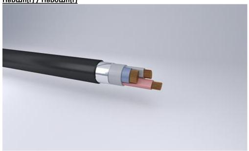
Кабели силовые с медными жилами, изоляция из вулканизированного полиэтилена, с защитным покровом типа БШп, герметизированный
