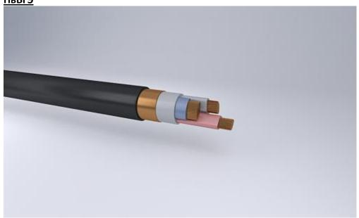
Кабели силовые с медными жилами, изоляция из вулканизированного полиэтилена и оболочка из ПВХ пластиката, без защитного покрова, экранированный
